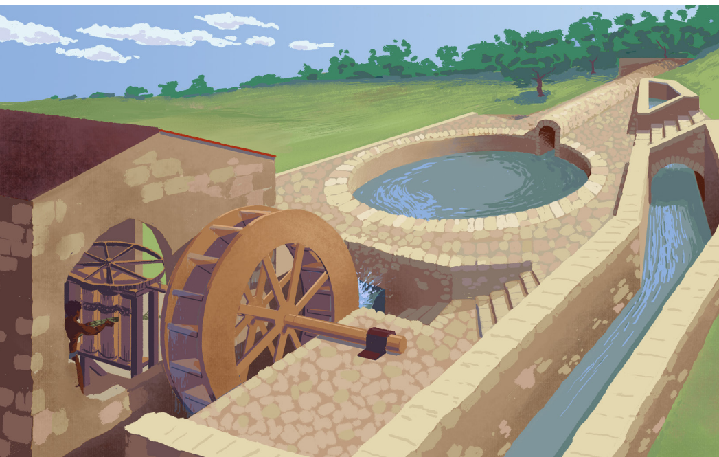
Ilustración interpretativa del sistema hidráulico INGENIO DIEGO CABALLERO.
