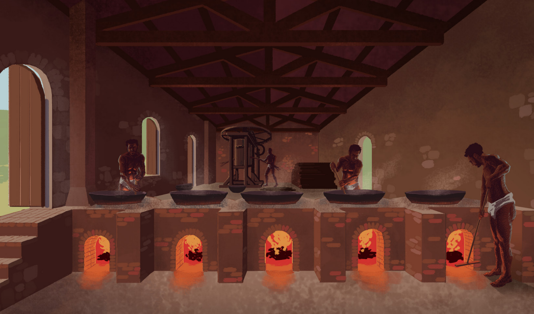
Ilustración interpretativa del proceso de cocción del tren de calderas INGENIO DIEGO CABALLERO.
